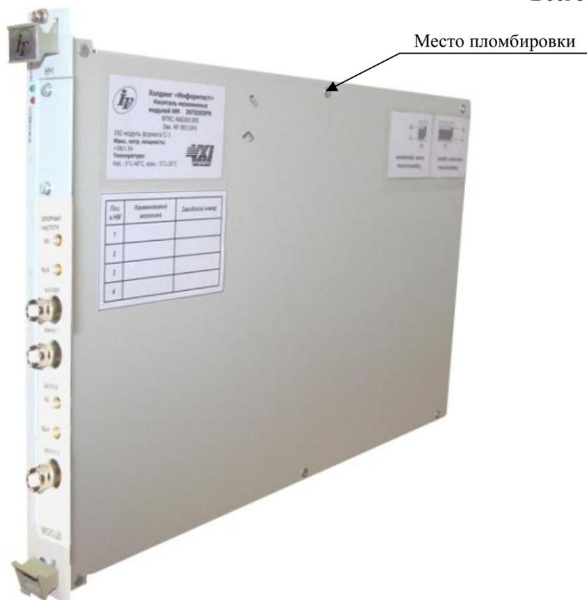
Рисунок 4 – Внешний вид носителя мезонинных модулей НМ-С (НМ, НМУ) с установленным осциллографом
