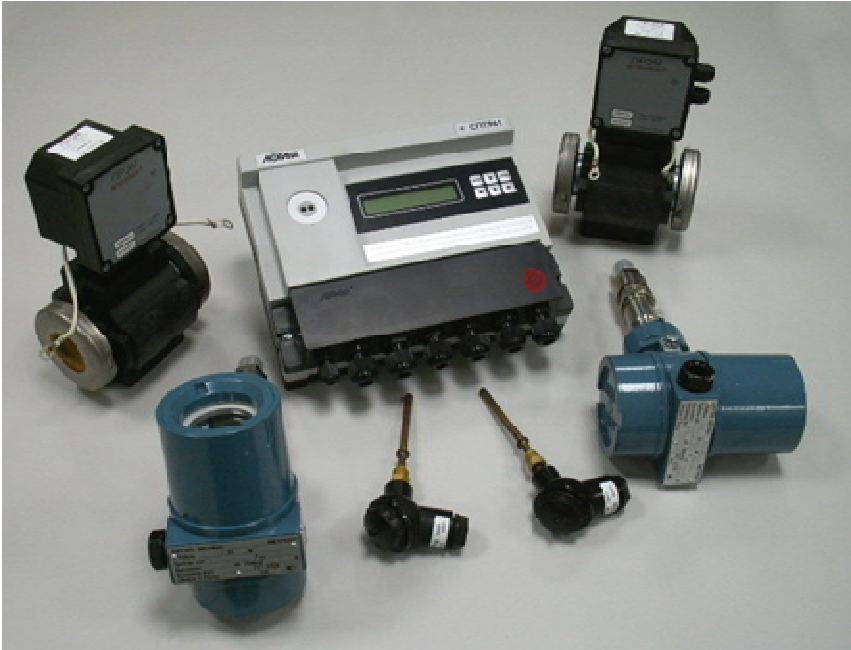
Общий вид теплосчетчиков
