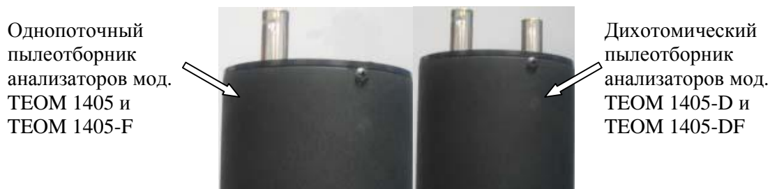
Рисунок 3 - Внешний вид однопоточного и дихотомического пылеотборников анализаторов модификаций TEOM 1405 и TEOM 1405-D
