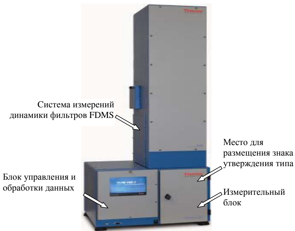
Рисунок 2 – Внешний вид анализаторов пыли модификаций ТЕОМ 1405-F и ТЕОМ 1405-DF и обозначение места для размещения знака утверждения типа
