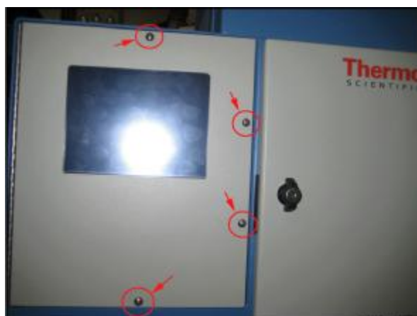
Рисунок 4 – Схема пломбировки анализаторов модификаций TEOM 1405, TEOM 1405-D, TEOM 1405F и TEOM 1405-DF от несанкционированного доступа
