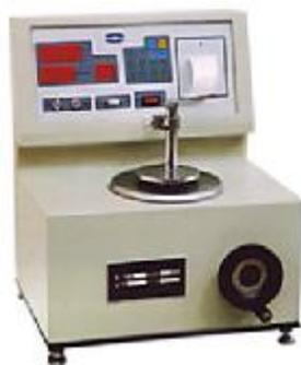
Рисунок 2 - Машина для испытаний пружин и материалов TIME TNS-S-L
