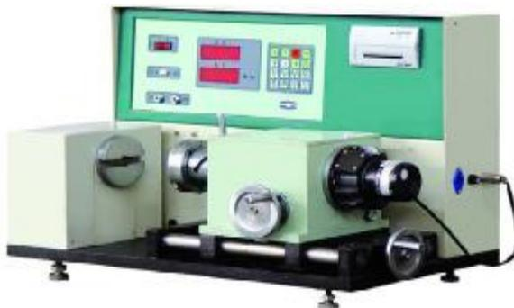
Рисунок 1- Машина для испытаний пружин и материалов TIME TNS-S
