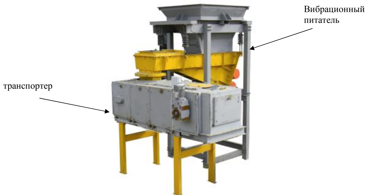
Рисунок 1 — Внешний вид дозатора с вибрационным питателем
