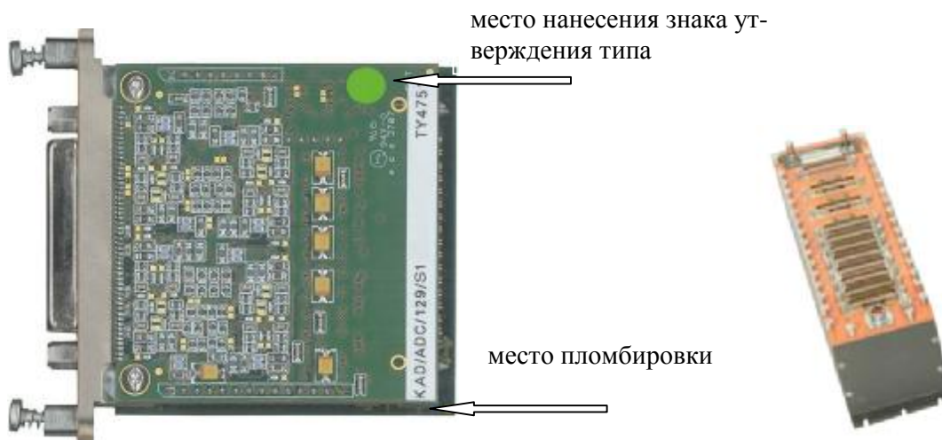
Рисунок 1 - Внешний вид модуля KAD/ADC/129/S1 и модуля KAD/ADC/129/S1 установленного в блок базовый КАМ/CHS/13U
