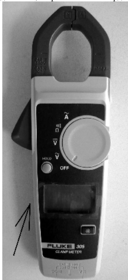
Рисунок 1 - Внешний вид клещей универсальных Fluke 302+, Fluke 303, Fluke 305, стрелкой показано место нанесения знака утверждения типа.
