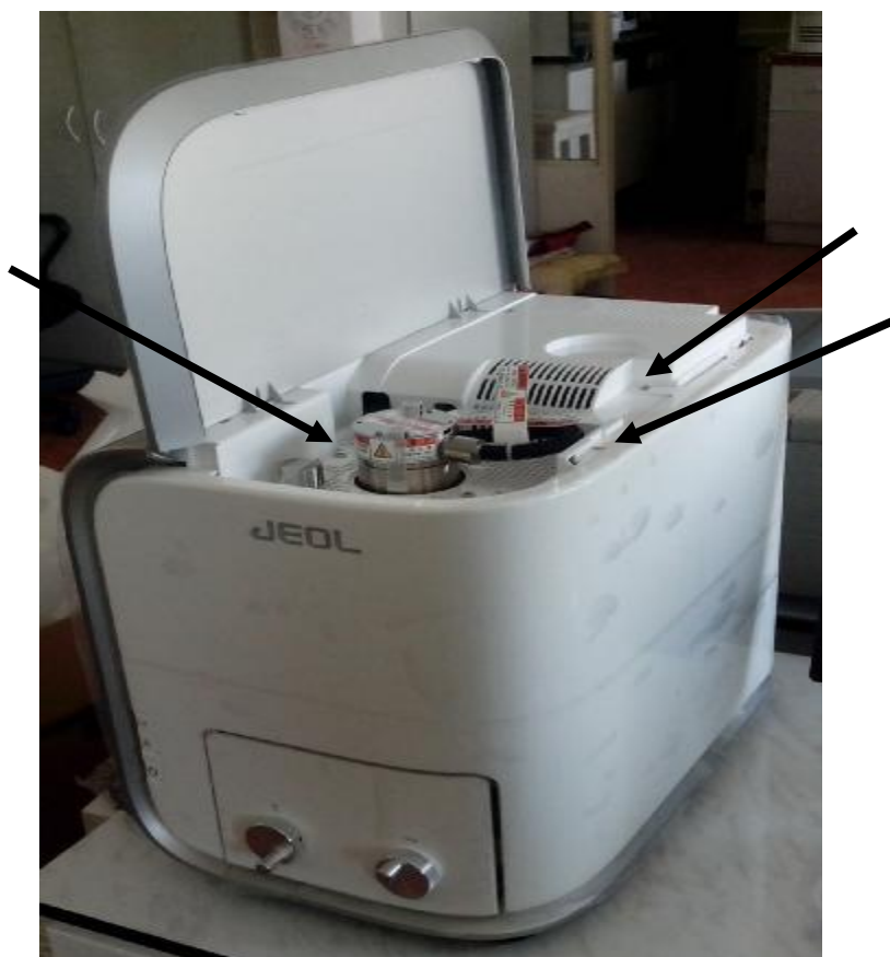
Рисунок 3 – Места пломбировки от несанкционированного доступа
