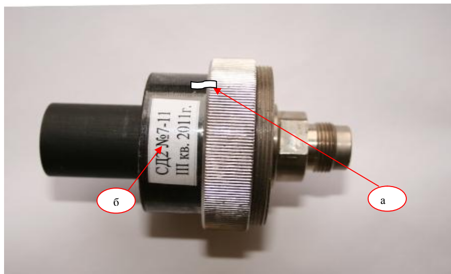
Рисунок 2 – Схема пломбировки (а) и места нанесения наклейки (б)
