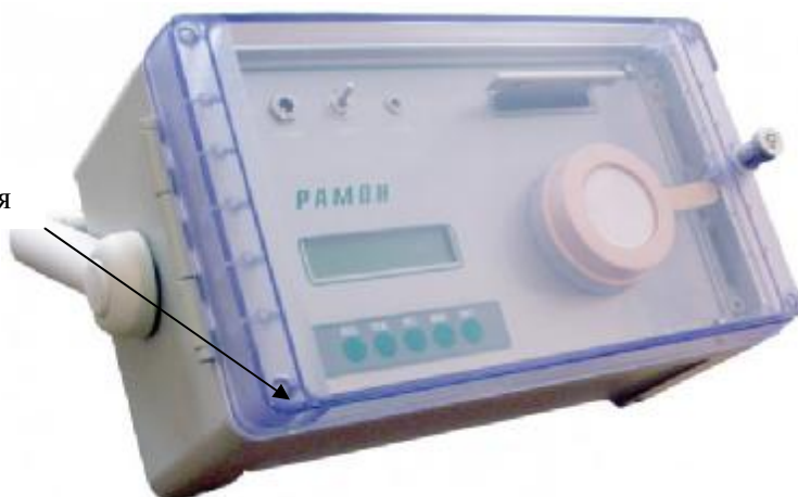
Рисунок 1 – Общий вид Радиометра радона и его дочерних продуктов распада «Рамон-01М»
