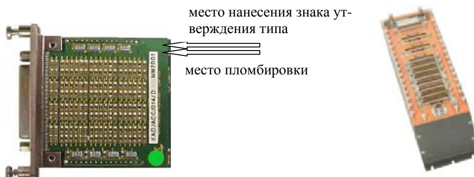
Рисунок 1 - Внешний вид модуля KAD/ADC/014 и модуля KAM/ADC/014 установленного в блок базовый KAM/CHS/13U
