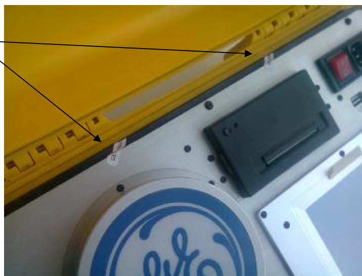
Рис. 2 Схема пломбировки корпуса анализатора растворенных газов в трансформаторном масле Transport X.
