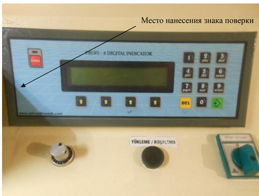
Рисунок 2 – Схема пломбировки пресса от несанкционированного доступа
