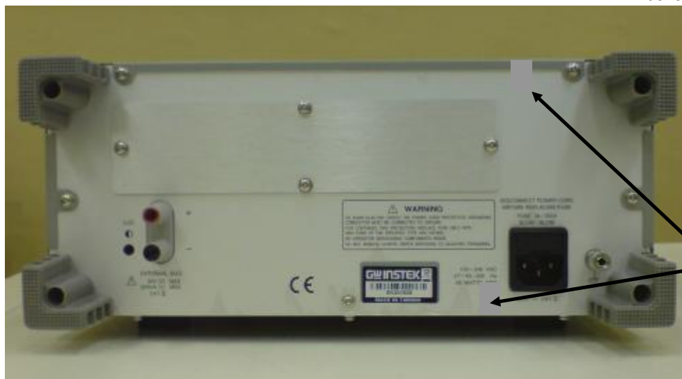
** - места пломбировки (нанесения наклеек) от несанкционированного доступа
