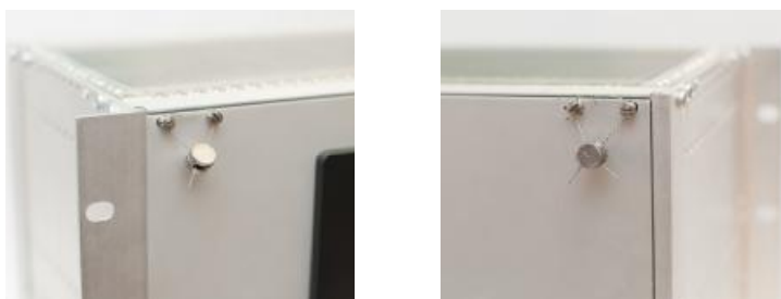
Рисунок 7 - Приборное исполнение, места пломбирования передней и задней панелей (место нанесения знака поверки)
