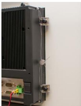
Рисунок 8 - Шкафное исполнение, место пломбирования компьютера (место нанесения знака поверки)
