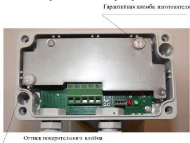
Фото 2 – Схема нанесения навесной пломбы и оттиска поверительного клейма в виде наклейки на переднюю панель преобразователя
