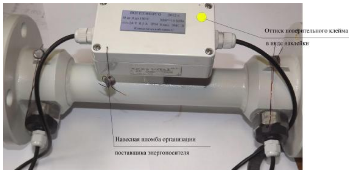
Фото 2 – Схема нанесения навесной пломбы и оттиска поверительного клейма в виде наклейки на переднюю панель преобразователя
