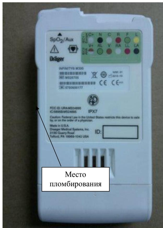
Рисунок 2. Внешний вид монитора пациента серии Infinity модели Infinity M300. Вид сзади
