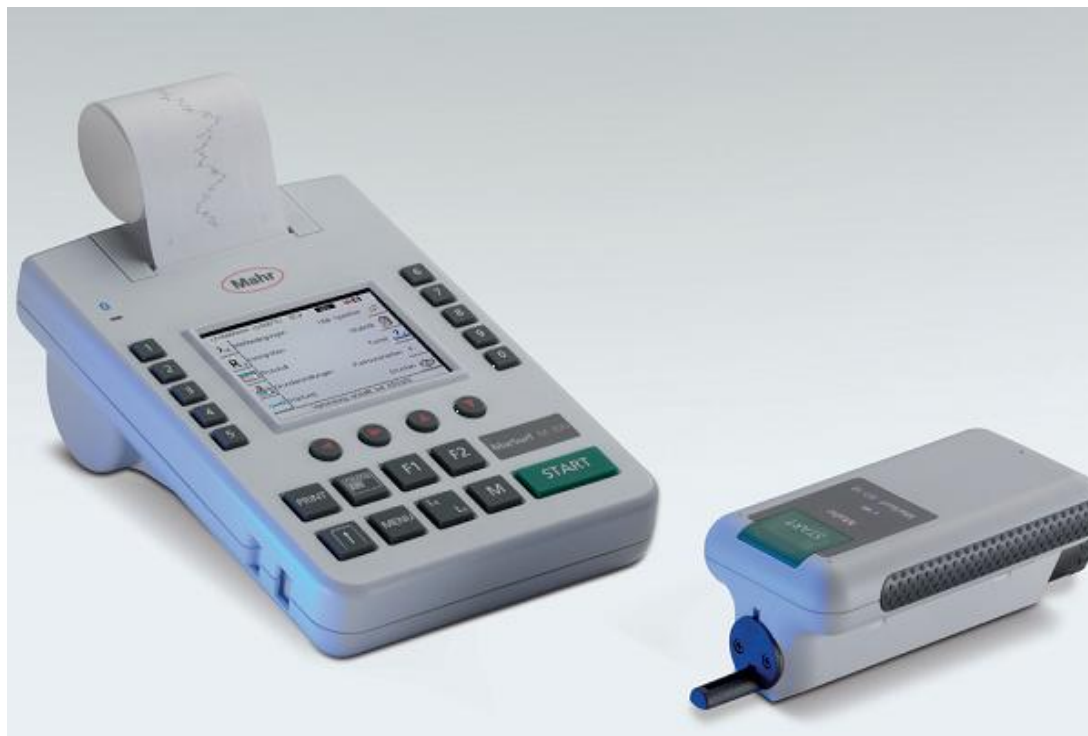
Рисунок 1 – Прибор для измерений шероховатости поверхности MarSurf M 300
