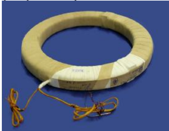
Рисунок 1 – Фотография общего вида трансформаторов тока встроенных ТВИМ-1
