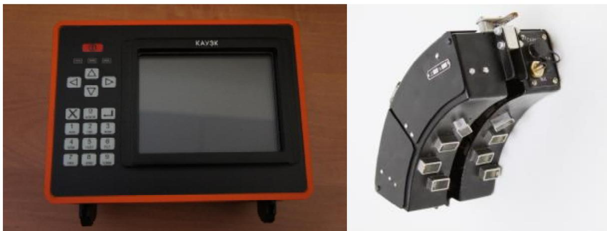
Рисунок 1. Общий вид электронного блока и сканирующего устройства комплекса КАУЗК
