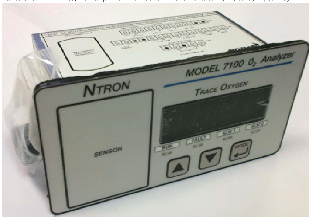
Рис.1 Фотография общего вида газоанализатора NTRON модель 7100
