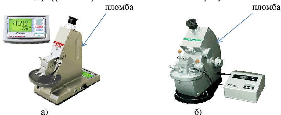
Рис. 1. Рефрактометры Аббе: а) модель DR-A1; б) модель NAR-3T
