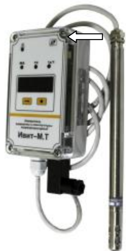
Рисунок 1 – Внешний вид измерителей влажности и температуры микропроцессорных с токовым выходным сигналом Ивит-М.Т конструктивного исполнения Н2 и место пломбирования (МП) корпуса
