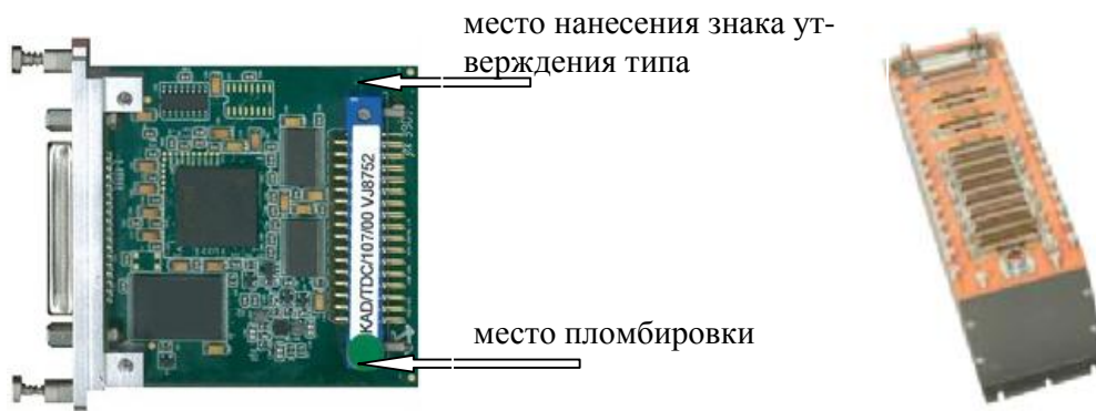
Рисунок 1 - Внешний вид модуля KAD/TDC/107 и модуля KAD/TDC/107 установленного в блок базовый КАМ/СНС/13U
