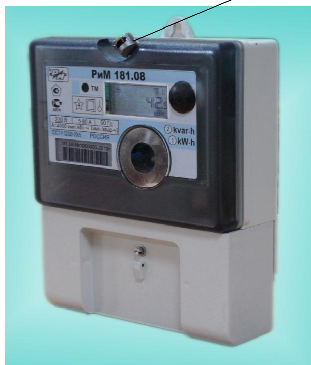
Рисунок 1 - Фотография общего вида и место установки пломбы поверителя счетчиков РиМ 181.08 производства ЗАО «Радио и Микроэлектроника»
