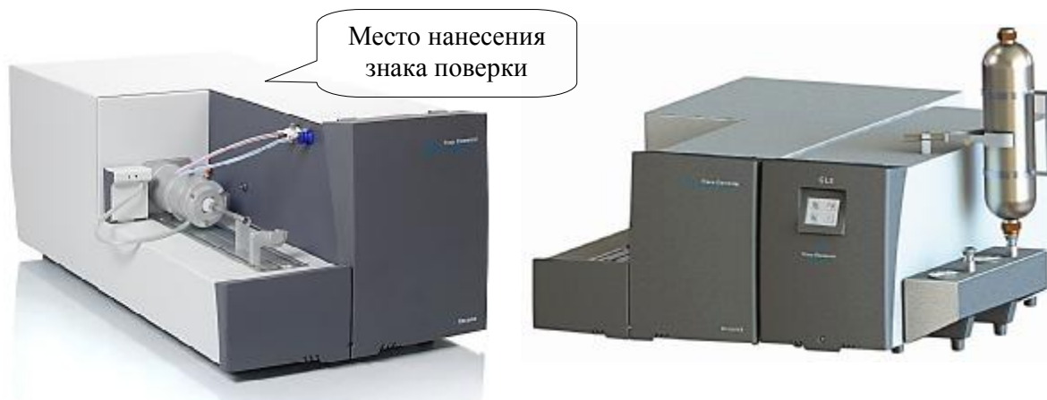
Рисунок 1 Внешний вид анализаторов Xplorer (справа с модулем GLS для ввода газообразных и сжиженных проб)
