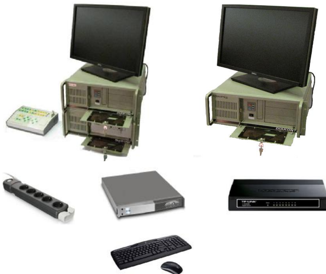
Рисунок 3 – Внешний вид оборудования приемной части системы измерения зазора между кожухом реактора и графитовой кладкой дистанционной — СК-Э(КЖ)
