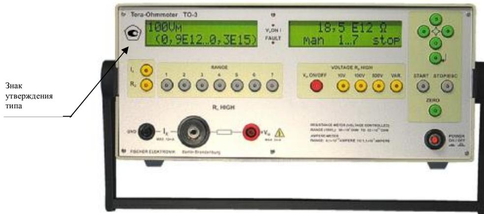
Рисунок 3 - Прибор для измерений электрического тока и сопротивления TO-3
