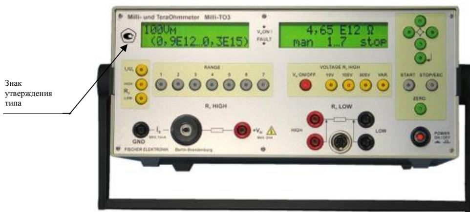
Рисунок 1 – Прибор для измерений электрического тока и сопротивления Milli-TO3
