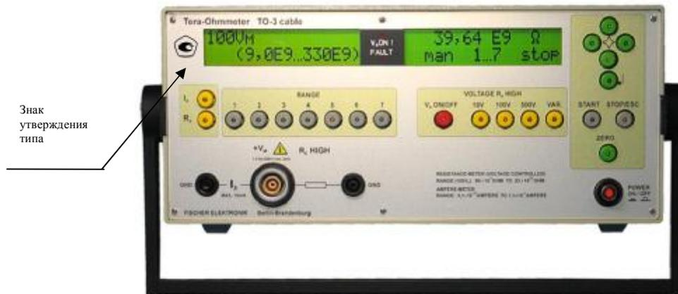
Рисунок 4 - Прибор для измерений электрического тока и сопротивления TO-3 cable
