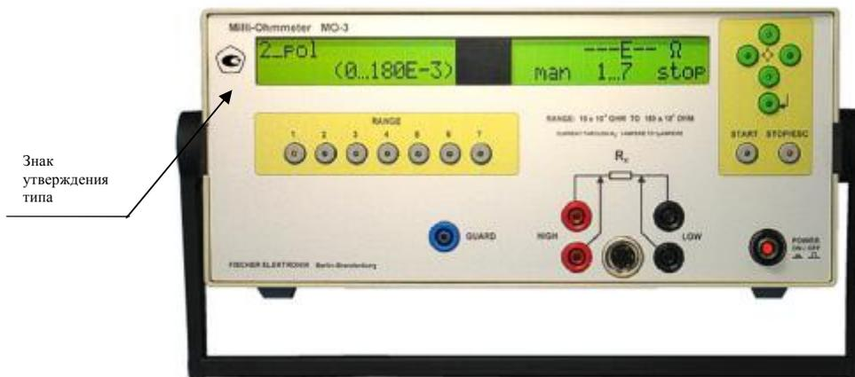
Рисунок 5 - Прибор для измерений электрического тока и сопротивления МО-3
