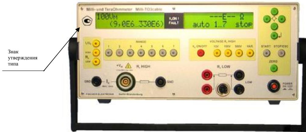
Рисунок 2 - Прибор для измерений электрического тока и сопротивления Milli-TO3 cable
