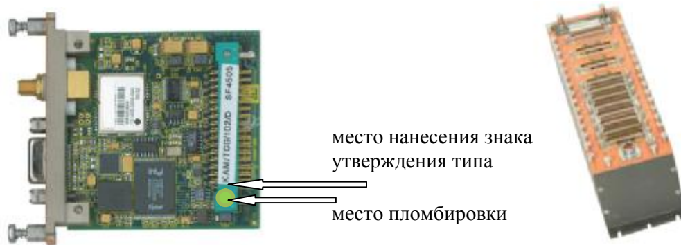
Рисунок 1 - Внешний вид модуля КАМ/ТСГ/102 установленного в шасси КАМ/СНС/13U
