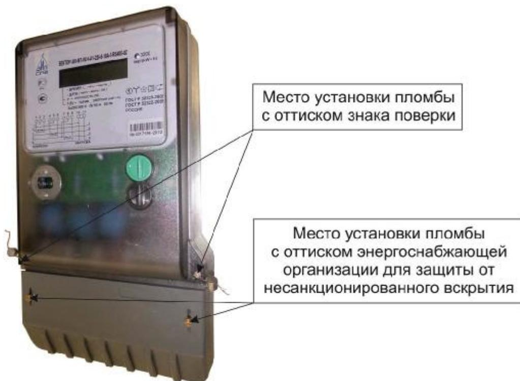
Рисунок 4 – Общий вид счетчика в корпусе модификации W34
