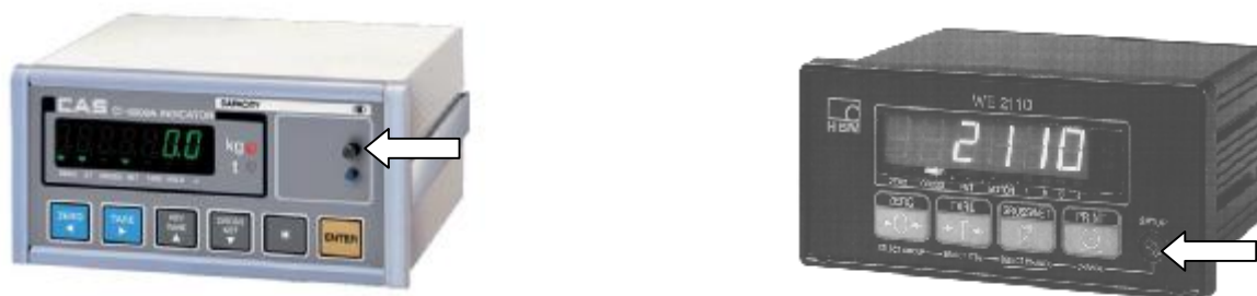
Рис. 2 Схемы пломбирования CI-6000A и WE2110
