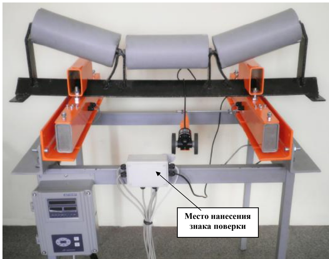
Рисунок 1 Общий вид весов. Место нанесения знака поверки - лицевая крышка клеммной коробки.
