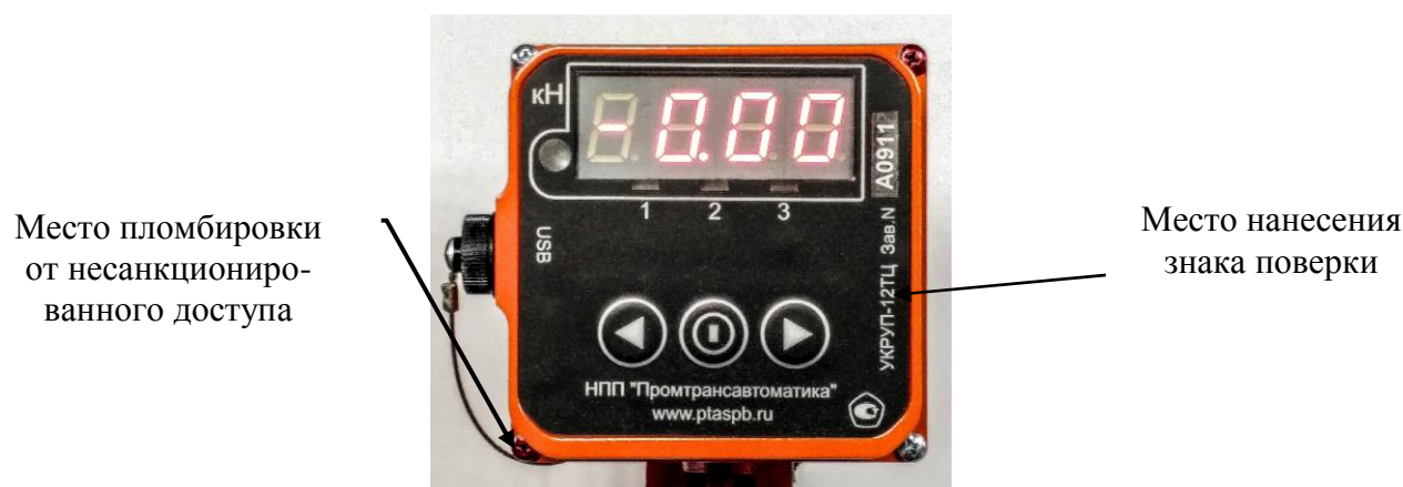
Рисунок 2 – Схема пломбировки от несанкционированного доступа и место нанесения знака поверки
