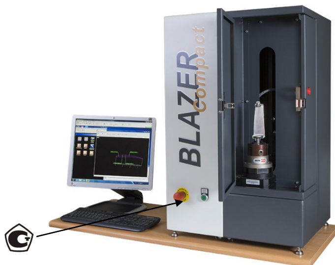
Рисунок 2 - Общий вид установки лазерной измерительной BLAZER Compact и место нанесения знака утверждения типа
