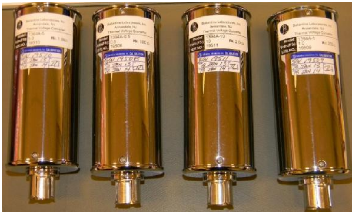
Рисунок 1 – Фотография общего вида комплекта преобразователей напряжения термоэлектрических Ballantine 1394A
