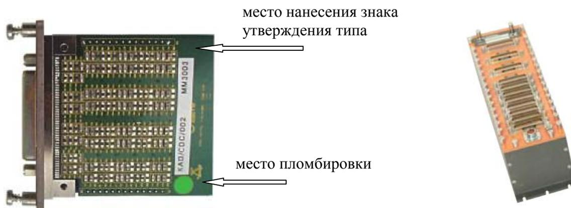
Рисунок 1 - Внешний вид модуля KAD/CDC/002 и модуля KAM/CDC/002 установленного в блок базовый KAM/CHS/13U
