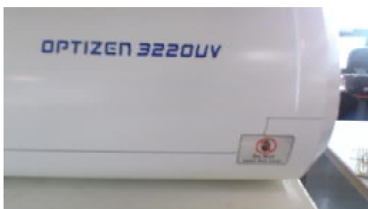
Рисунок 7 - Места нанесения маркировки и места пломбирования спектрофотометров OPTIZEN моделей OPTIZEN 3220UV, OPTIZEN 2120UV, OPTIZEN 1412V, OPTIZEN 1412SA, OPTIZEN POP, OPTIZEN POP bio, OPTIZEN POP QX
