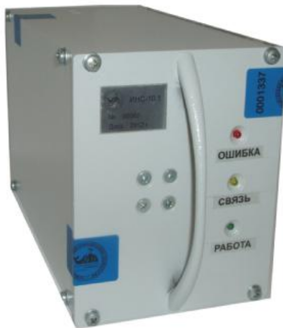
Рисунок 1 – Фотография общего вида измерителей напряжения и сопротивления ИНС-10.1
