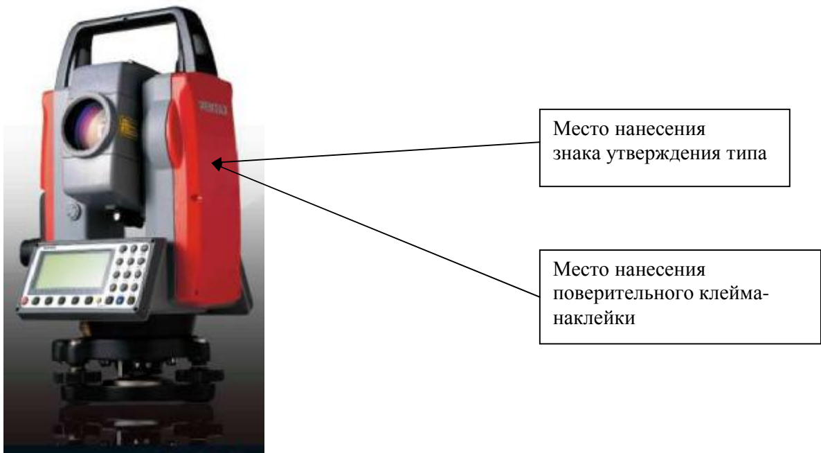
Рисунок 1-Общий вид тахеометра электронного PENTAX серии R-400V и место нанесения поверительного клейма и знака утверждения типа.
