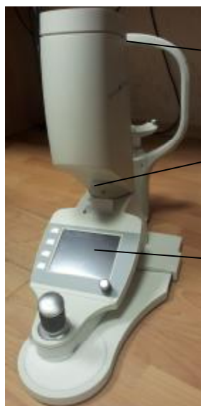
Рисунок 1 – Общий вид авторефкератометра с функцией пахиметрии PARK 1 и места его пломбирования
