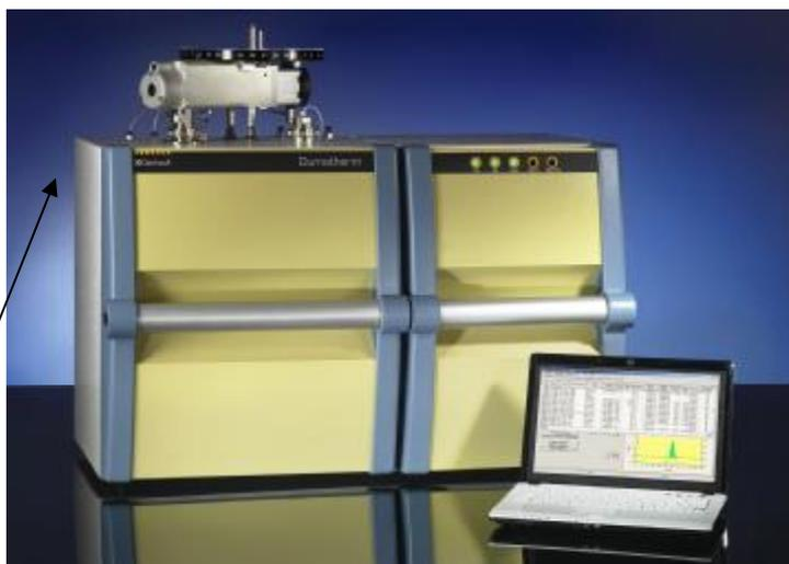
Рисунок 1 – Внешний вид анализатора азота/белка Dumatherm
