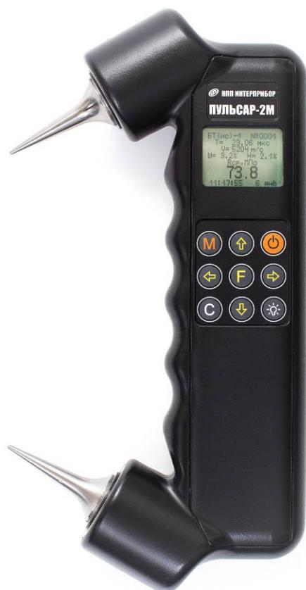
Рисунок 5 - Общий вид ПУЛЬСАР-2М
