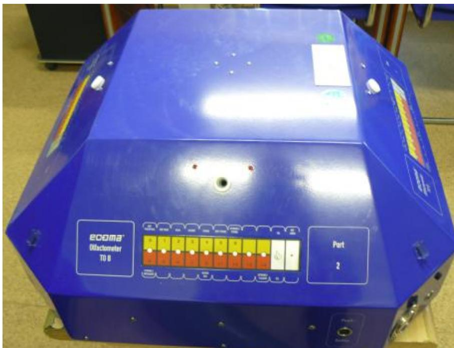
Рисунок 1 – Внешний вид ольфактометра ТО8
