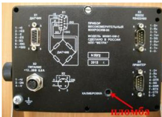
Рисунок 2 Общий вид и место пломбирования Микросим 06
