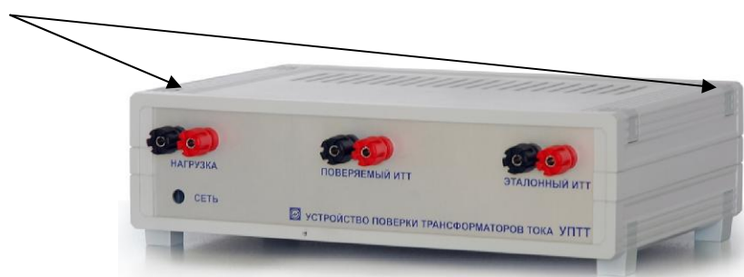
Рисунок 4 - Общий вид и места пломбировки Устройства поверки трансформаторов тока УПТТ (пломбы устанавливаются на винтах под крышками)
