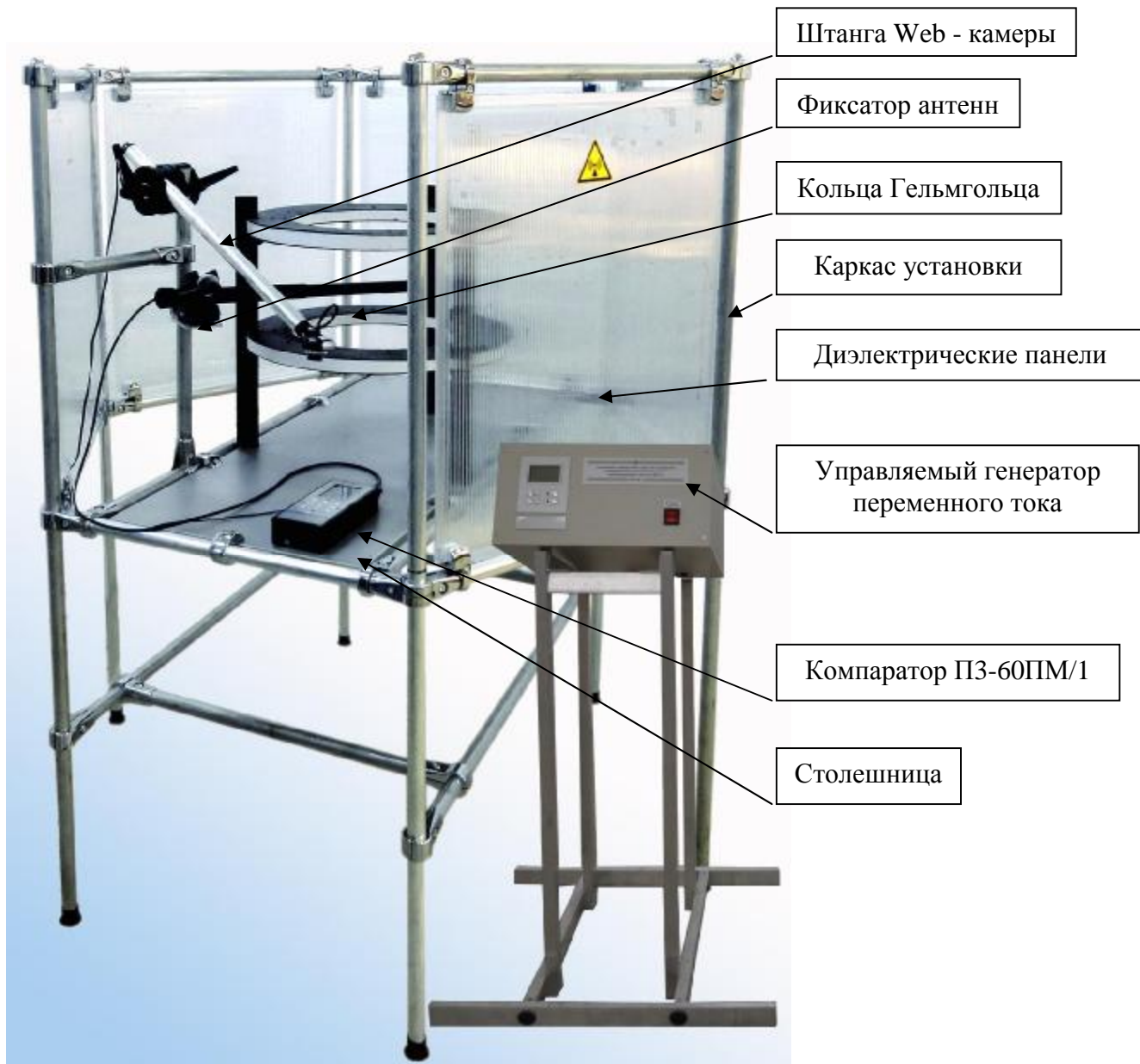
Рисунок 1 – Общий вид установки поверочной средств измерений напряженности магнитного поля промышленной частоты П1-26
