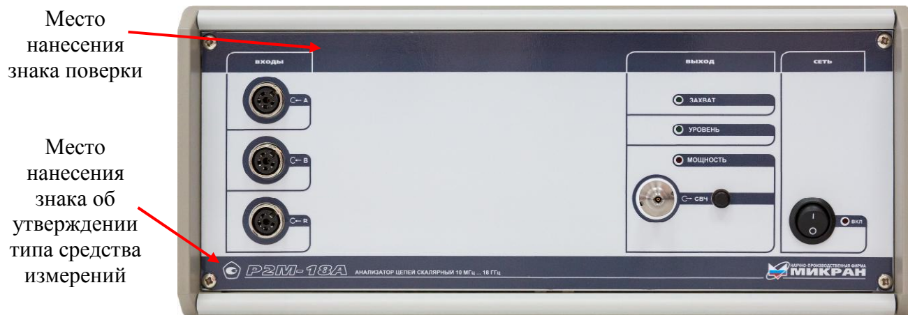
Рисунок 1 - Внешний вид анализаторов цепей скалярных P2M-18A/3, P2M-18A/4, P2M-18A/7, P2M-18A/8
