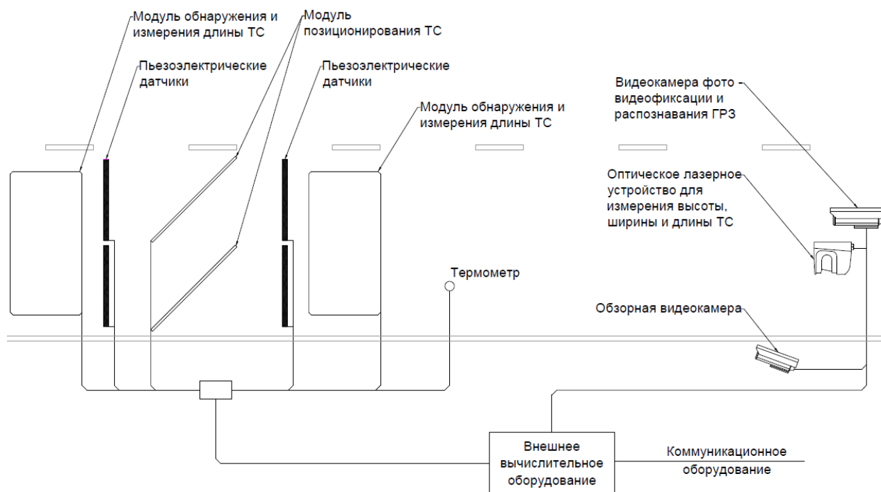
Рисунок 2 - Схематический вид системы UnicomWIM
