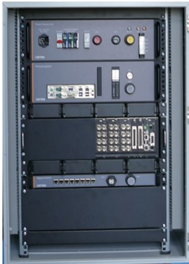
Рисунок 4 - Шкаф управления системы UnicamWIM с блоком обработки сигналов UC-ZPU (пример)
