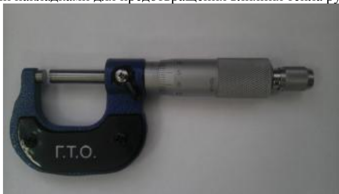
Рисунок 1 - Общий вид микрометров гладких нониусных
