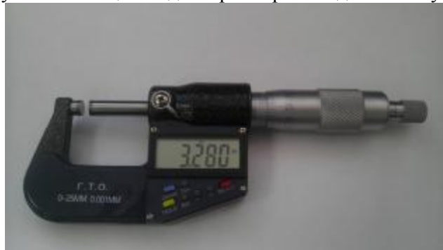
Рисунок 2 - Общий вид микрометров гладких цифровых
