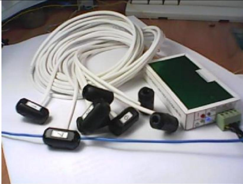
Рисунок 1 – Функциональный модуль БТ05-001-08 с датчиками напряжения.
